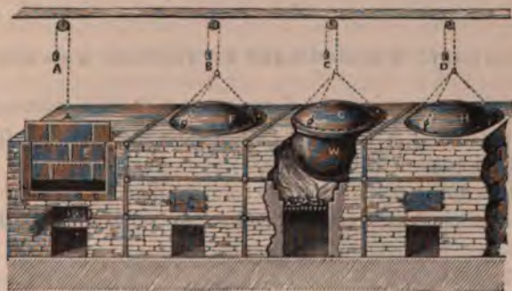
Fig. 214. — Sublimation du sel ammoniac dans des chaudières de fonte.
